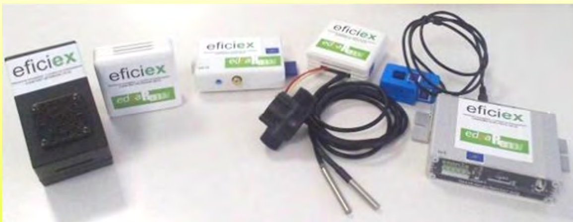
Sistema de sensores eficiex. De izquierda a derecha: (1) Sensor de confort interior, (2) sensor de confort exterior, (3) estación base (Raspberry Pi®), (4) sensor de consumo de agua y combustible y (5) sensor de consumo eléctrico.
